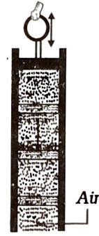
চিত্র 15.4 পিষ্টনটো অগা-পিছা কৰি বায়ুপূৰ্ণ নলীত অনুদৈৰ্ঘ্য তৰংগ (শব্দ) সৃষ্টি কৰা হৈছে। বায়ুভাগ তৰংগ সঞ্চাৰণৰ সমান্তৰাল দিশত দোলে।
